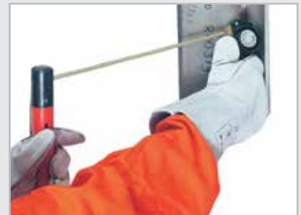
El controlador remoto inalámbrico R11-T se activa simplemente tocando el electrodo
