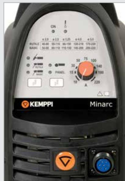
La Minarc 220 es fácil de configurar. La selección del tipo de electrodo garantiza la mejor calidad de soldadura, también puede usar un control remoto opcional para el ajuste fino de la corriente durante la soldadura.
