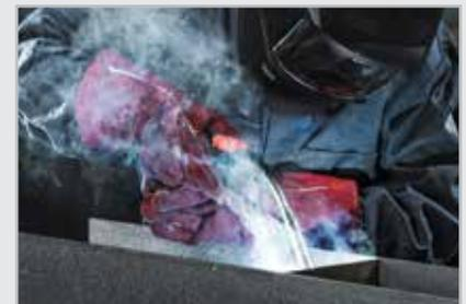
El proceso MIG/MAG de X3 MIG Welder se ha ajustado cuidadosamente para aportar al arco de soldadura una estabilidad sobresaliente, por lo que resulta fácil de manejar y produce muy pocas salpicaduras, también al usar el económico gas de protección CO<sub>2</sub>. Cuando se reduce la necesidad de esmerilado tras la soldadura, los soldadores pueden centrarse en la soldadura productiva.
