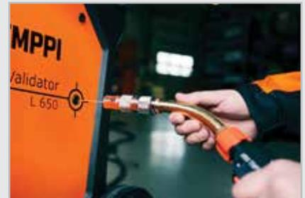
Además, ArcValidator cuenta con un dispositivo integrado para la medición de la velocidad de alimentación del alambre.
