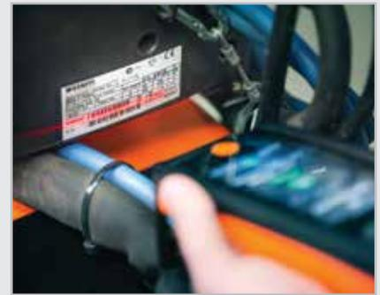
ArcValidator RC registra todos los datos de los procesos de validación para la posterior transferencia al software del PC.
