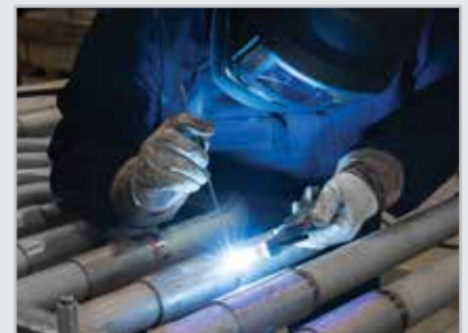
La MinarcTig 250 es una soldadora ideal para tareas de fabricación de chapas finas. Su baja corriente de ignición y arco estable facilitan las soldaduras de calidad.
