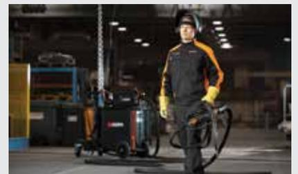
El subalimentador ligero es una alternativa ergonómica al transporte de alimentadores de alambre grandes y pesados, o a la soldadura con pistolas de retrotracción intensa que incrementan la presión en la muñeca del soldador.
