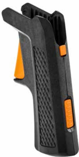
El mango de pistola es un accesorio estándar que se incluye en todos los paquetes de pistolas de soldar Flexlite GX. Permite adoptar una posición natural de la muñeca, lo que facilita y aligera el trabajo, especialmente durante las soldaduras largas. Rápida de instalar y desinstalar sin herramientas.
