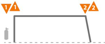
Si se utiliza la partida en caliente con 4T, al pulsar el disparador se inicia el pregás durante un tiempo predefinido, tras el cual el arco se enciende automáticamente y la corriente aumenta hasta el nivel de partida en caliente. Una vez que se suelta el disparador, la corriente desciende hasta el nivel de corriente de soldadura normal. Si se suelta el disparador antes de que la secuencia de arranque alcance la fase de partida en caliente, el arco se enciende sin partida en caliente.
